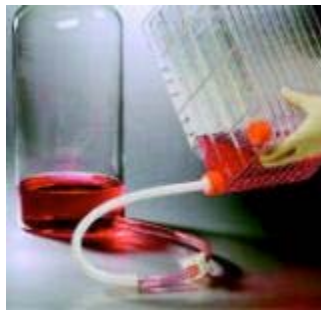
Figure 7. bouchons optionnels de remplissage pour le transfert aseptique direct des milieux
